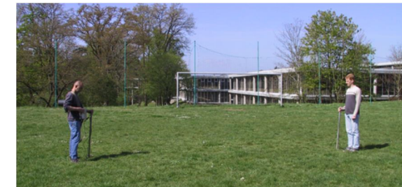
Prise de mesure en mode électrique (Calligée)
