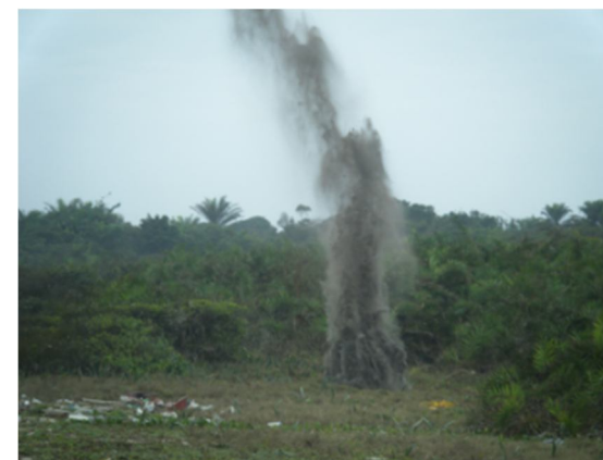
Tir sismique à l'explosif (Document AGAP)
