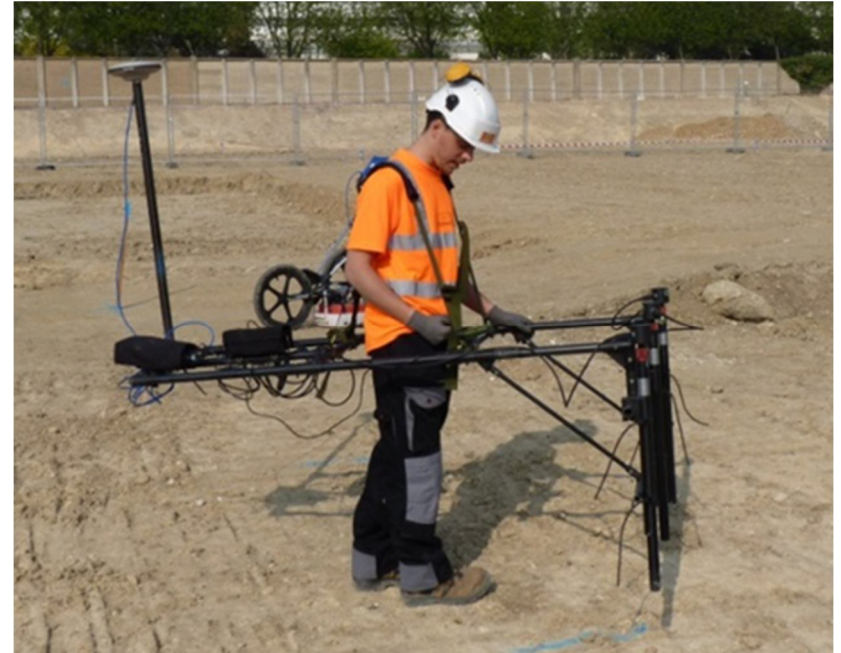
Montage 4 sondes géoréférencées portées manuellement
