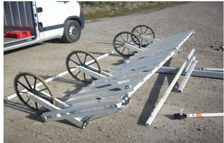
Exemple de montage d'un cadre 8 sondes
