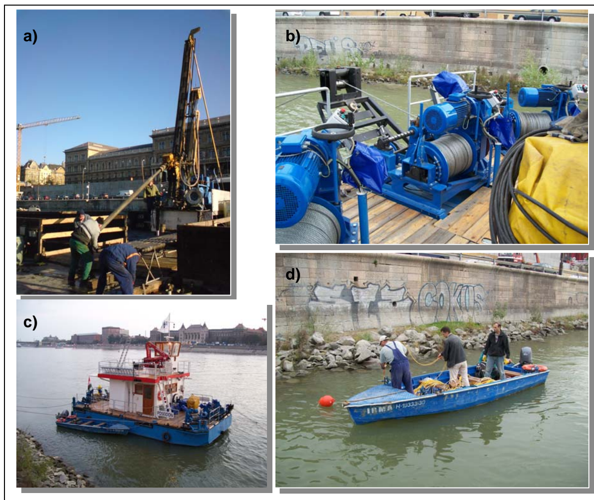
Figure 6 : Acquisition des données a) en forage, b) de résistivité électrique, d) de sismique réfraction. c) Bateaux utilisés pour l'acquisition.
