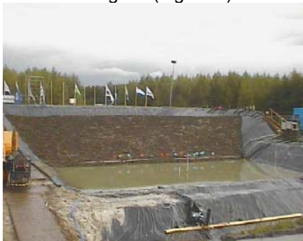
Figure 3 : Digue test au cours d'un essai Ijkdijk de rupture par érosion interne
