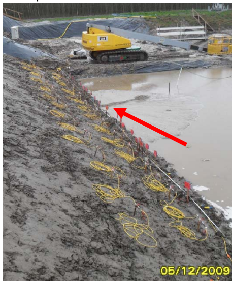
Figure 4. Photographie de l'ouvrage prise le 5 décembre 2009 à 12 h 54. La flèche rouge indique la zone d'érosion au niveau de l'électrode PS n°10.
